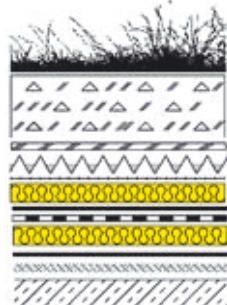
ekstensywny termiczny system duo-dach
